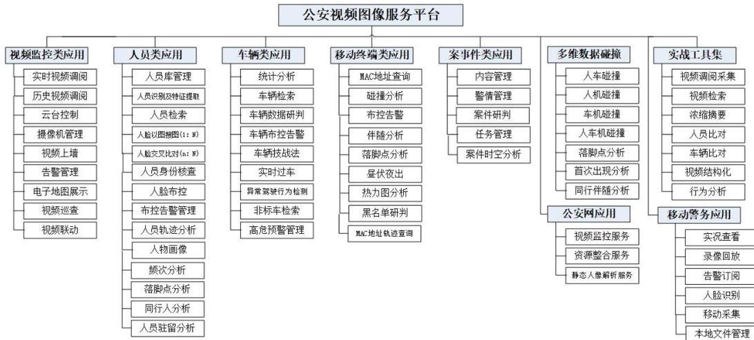
图 5.4-4 公安视频图像服务平台功能架构图
